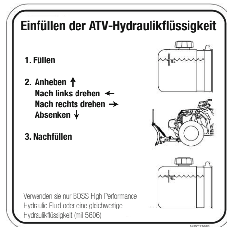
Abbildung 14. Verfahren für das Einfüllen der Hydraulikflüssigkeit MSC13663
