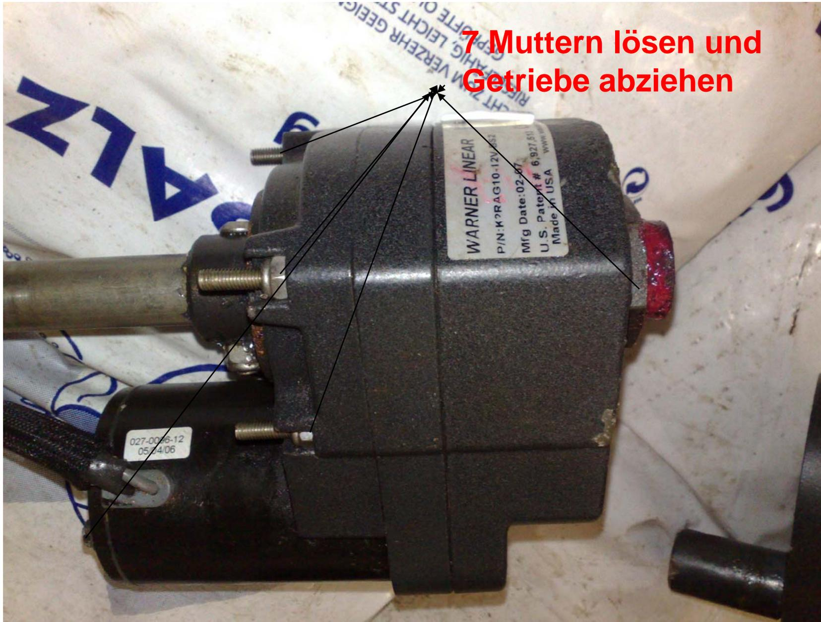
Getriebe im ausgebauten Zustand
