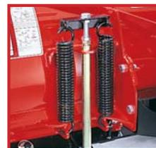
Unsere Federklappen Pflüge sind mit Verlängerungs- Typ Feder-Mechanismus ausgestattet. Erlaubt die Einstellung der Federspannung für die unterschiedlichen Aufgaben.
