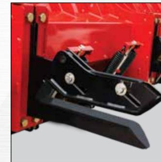
Die **Universal-Gabelhalterung** ist so konzipiert, dass sie schnell und einfach mit einem einfachen Schlitten angebaut werden kann.
