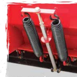
**Einstellbare, hochbelastbare Auslösefedern** sind unerbittlich geprüft und ermöglichen es dem Bediener, die Trip-Edge-Spannung entsprechend der jeweiligen Aufgabe einzustellen.
